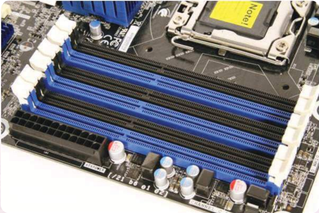
شكل (٦-٩): المسارات المخصصة لتوصيل وحدات الذاكرة في اللوحة الحاضنة
