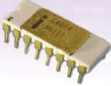
شكل (٣-٦): المظهر الخارجي للمعالج الدقيق (4004)
