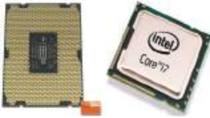
شكل (٤-٦): المعالج (Core i7)، مع إيضاح صورة سطح وظهر المعالج
