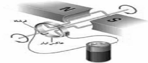
الشكل 20-5 يسمح عاكس التيار (حلقة فلزية مشقوقة) في المحرك الكهربائي بتغيير اتجاه التيار المار في الحلقات السلكية، وبذلك تتمكن الحلقات في المحرك من الدوران  $360^\circ$ .
