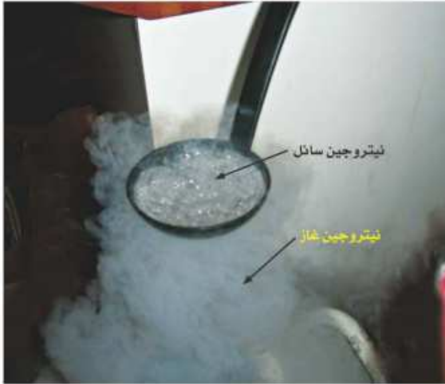
الشكل ٦ يتحول النيتروجين المسال إلى غاز فور تعرضه لحرارة الغرفة، فدرجة غليان النيتروجين ( -195.8^{\circ}\text{C} ) أقل بكثير من درجة حرارة الغرفة.
