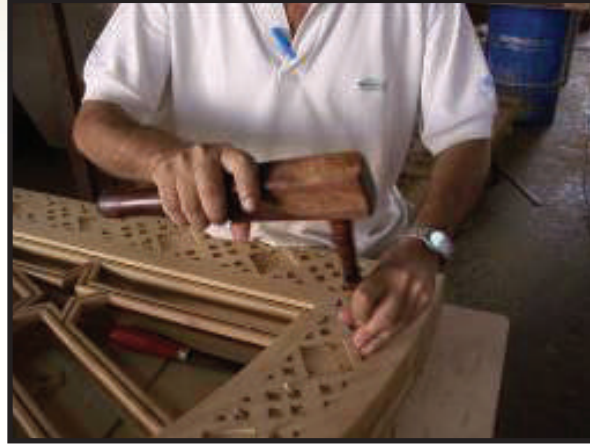
(١): استخدام المدق الخشبي، وهي الأداة الصحيحة.
