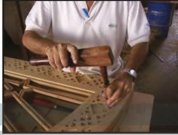
(١): استخدام المدق الخشبي، وهي الأداة الصحيحة.
