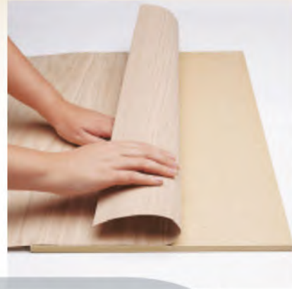
الشكل (١٦٠): تستخدم القشرة لتغطية الأسطح الخشبية على مساحات كبيرة .
