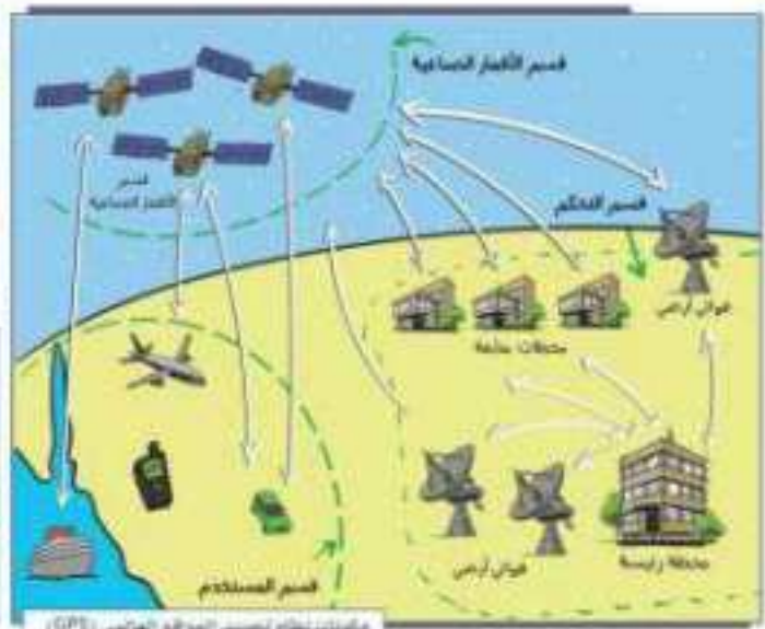
مكونات نظام تحديد المواقع العالمي (GPS)
