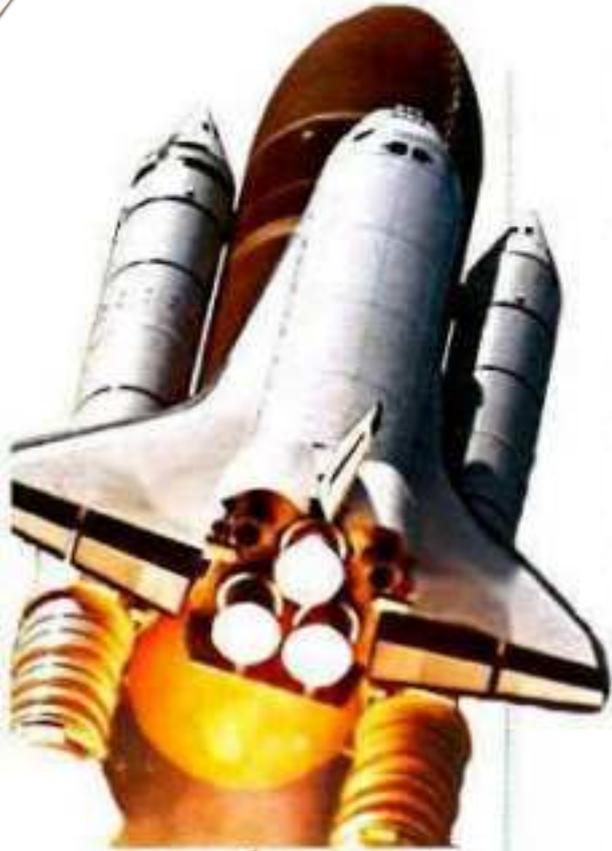
الشكل ١٤: يندفع المركب الفضائي نتيجة تفاعل الهيدروجين والأكسجين، الذي ينتج طاقة هائلة، ومركب الماء. فسر لماذا تُعدّ السيارة التي تحرق الهيدروجين بدلا البنزين صديقة للبيئة.
