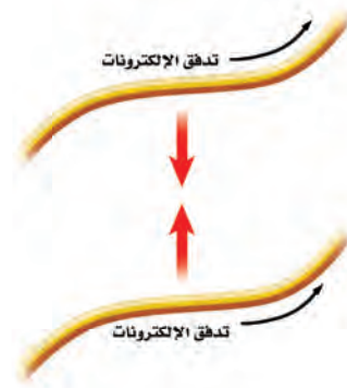
الشكل ١٢ يتجاذب السلكان اللذان يسري فيهما تياران كهربائيان في الاتجاه نفسه، كالأقطاب المغناطيسية المختلفة تماماً.
