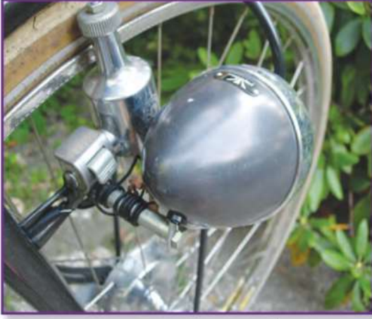
يتصل المولد الكهربائي بعجلة الدراجة
