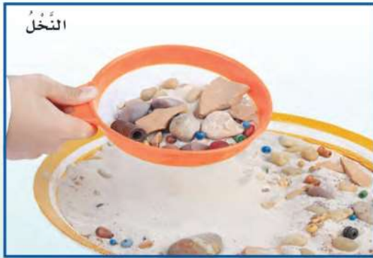
يستخدم المنخل لفصل مواد مختلفة الحجم.
