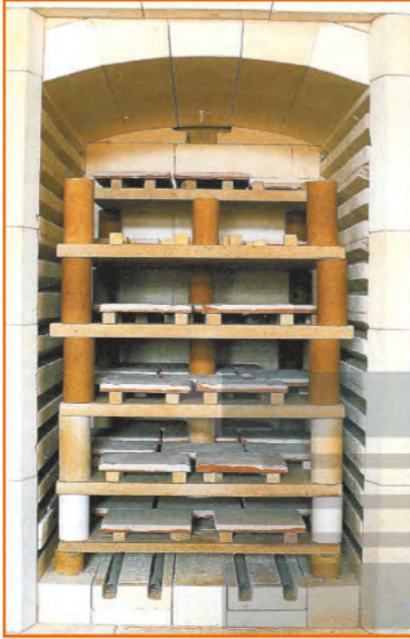
الشكل (٦١): طريقة رص القطع الطينية في الفرن الكهربائي.
