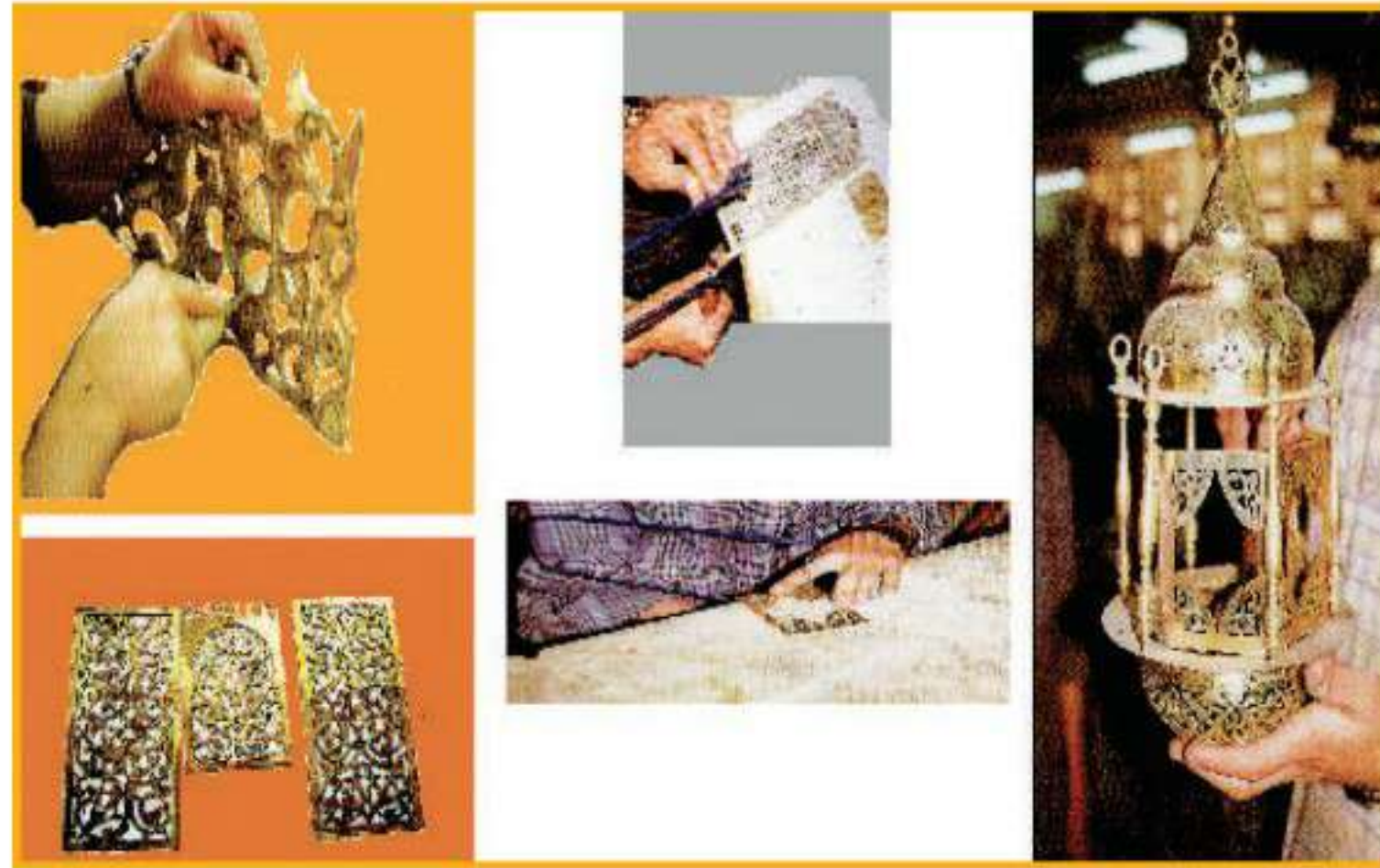
الشكل (٥٥): طرق استخدام أزاميل ومنشار المعادن
