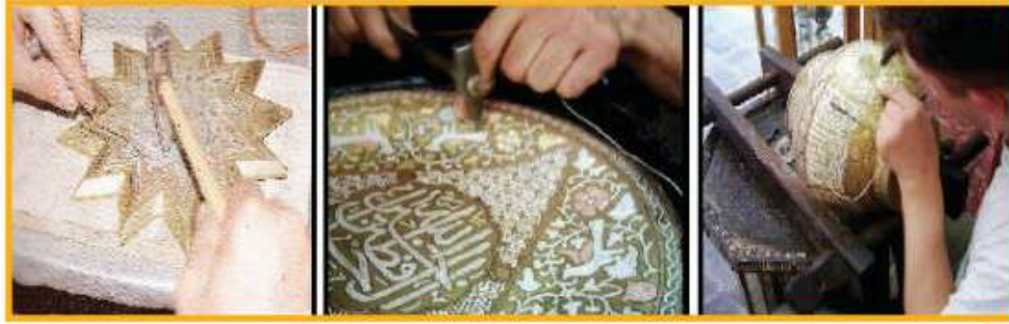
الشكل (٨٢): طريقة التكفيت
