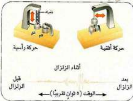
طريقة عمل جهاز الميسمو جراف
