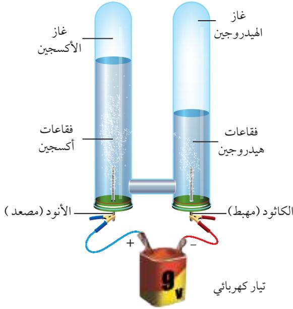
الشكل 18-2 يتحلل الماء إلى مكوناته: الأوكسجين والهيدروجين بعملية التحليل الكهربائي.
