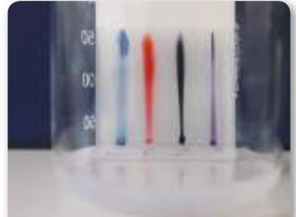
الشكل 14-2 تتفصل المكونات المختلفة للحرير بناءً على قابلية انجذاب كل مكون من مكونات الحبر (الطور المتحرك) لسطح ورق الكروماتوجرافيا (الطور الثابت)
