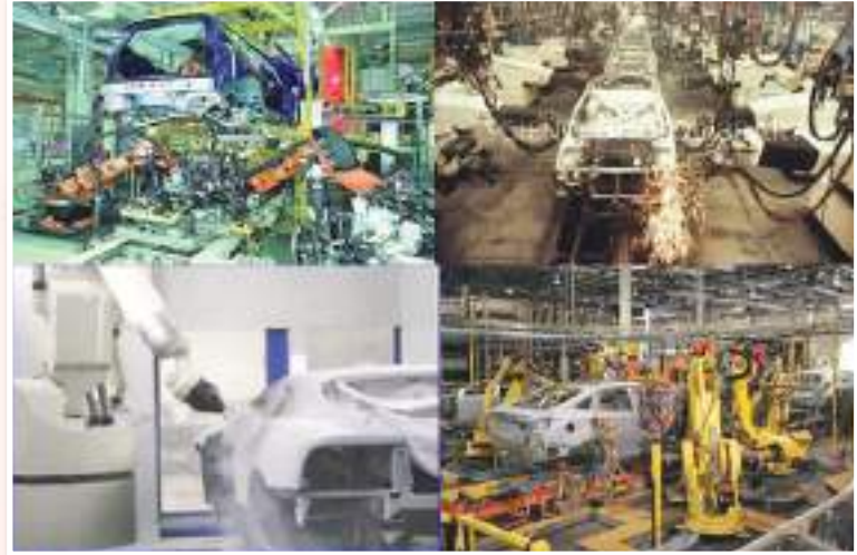
شكل (٢-٤): مجموعة الروبوتات تعمل في خطوط تجميع السيارات
