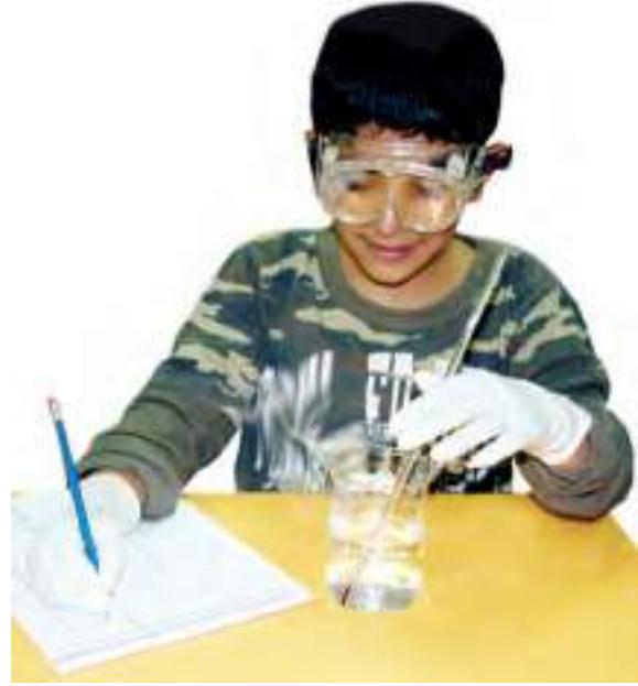
الشكل ١٤ يستخدم مقياس الحرارة لقياس درجة حرارة الأجسام. ومعظم مقاييس الحرارة في المختبرات هي عبارة عن أنبوب زجاجي في نهايته مستودع، يحتوي على سائل مثل الكحول الملون. ويرتفع السائل في الأنبوب أو ينخفض كلما تغيرت درجة الحرارة. ولقراءة درجة الحرارة حرك المقياس بشكل دائري حتى تتمكن من مشاهدة السائل الملون، وقرأ درجة الحرارة عند نهاية السائل.
