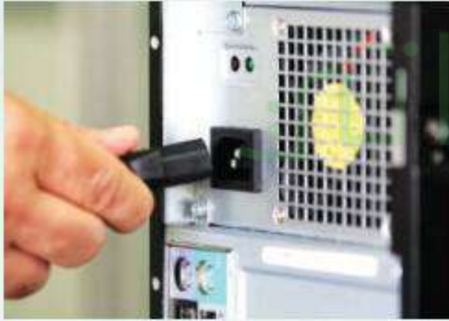
شكل (٢-١-١): فصل التيار الكهربائي عن جهاز الحاسب الشخصي
