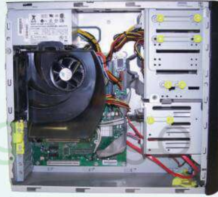
شكل (٢-٤): اللوحة الحاضنة داخل صندوق الحاسب
