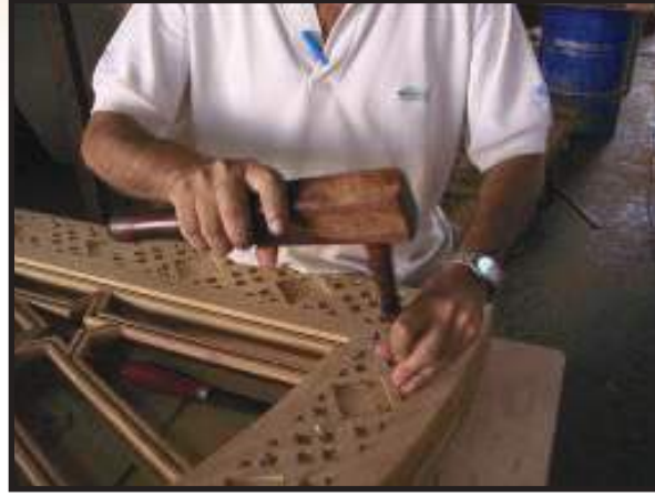
(١): استخدام المدق الخشبي، وهي الأداة الصحيحة.
