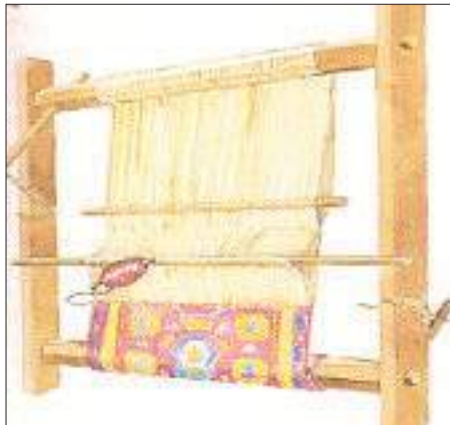
الشكل (١٧٧): نول الكليم ويلاحظ فيه تباعد خيوط السدى بما يتناسب مع التصميم المرسم.
