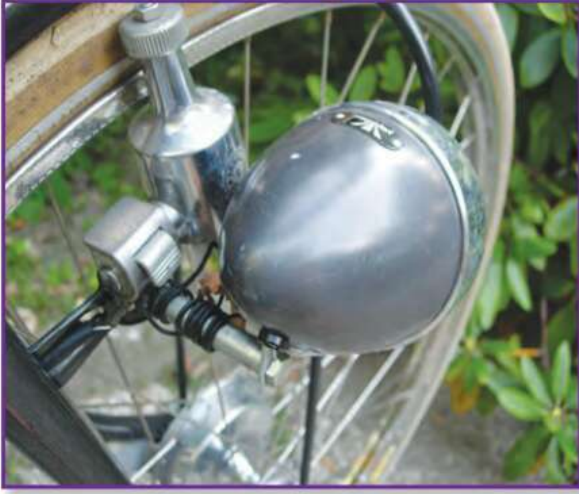
يتصل المولد الكهربائي بعجلة الدراجة
