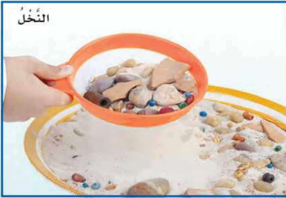
يستخدم المنخل لفصل مواد مختلفة الحجم.
