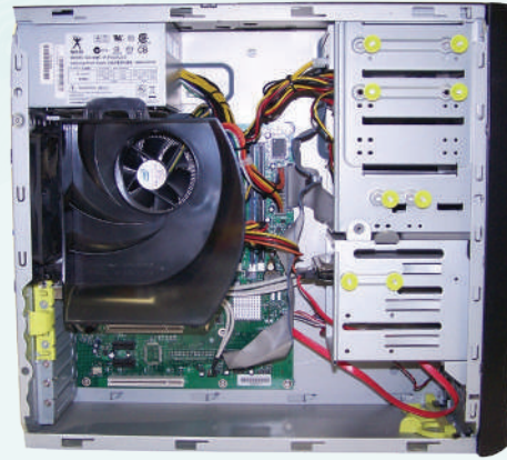
شكل (٤-٢): اللوحة الحاضنة داخل صندوق الحاسب
