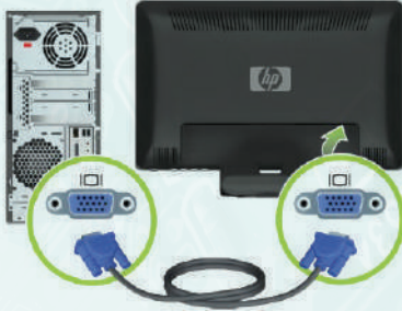
شكل (٨-١-٢): توصيل سلك الشاشة بالمنفذ المناسب له خلف صندوق الحاسب
