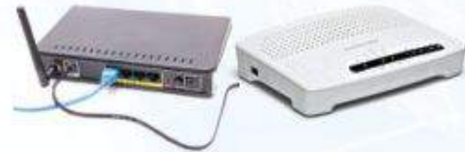
شكل (٨-١): توصيل سلك الهاتف بجهاز المودم
