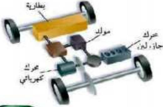
الشكل ١٠ تستعمل السيارات المهجنة (الهايبرد) المحرك الكهربائي ومحرك الجازولين، مما زاد من فاعلية تحويلات الطاقة.
