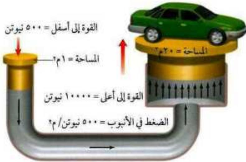
الشكل ٢٥ بزيادة مساحة مقطع المكبس الأيمن تزداد القوة المؤثرة فيه. وبين الشكل أن القوة الصغيرة المؤثرة في المكبس الصغير تنتج قوة كبيرة عند المكبس الكبير، فتكون القوة كافية لرفع السيارة.
